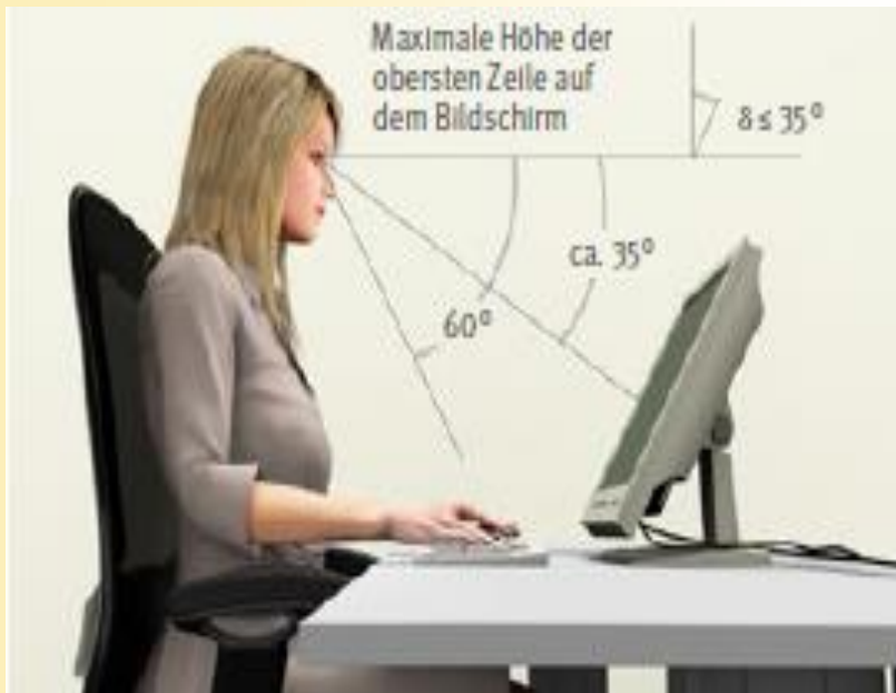
Vertikales Blickfeld und Anordnung des Bildschirms
