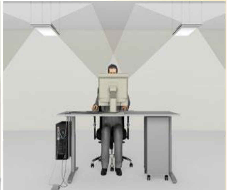
Anordnung der Beleuchtung Mindestbeleuchtungsstärke 500 Lux am Arbeitsplatz, dann muss die Beleuchtung gewartet werden. Siehe DGUV 215-410
