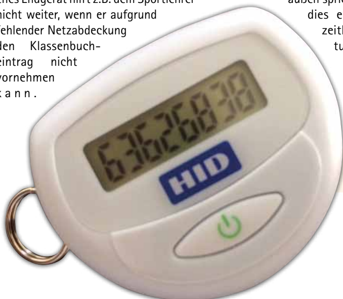
Ein Token generiert ein Passwort und ermöglicht so die Zwei-Wege-Authentifizierung
